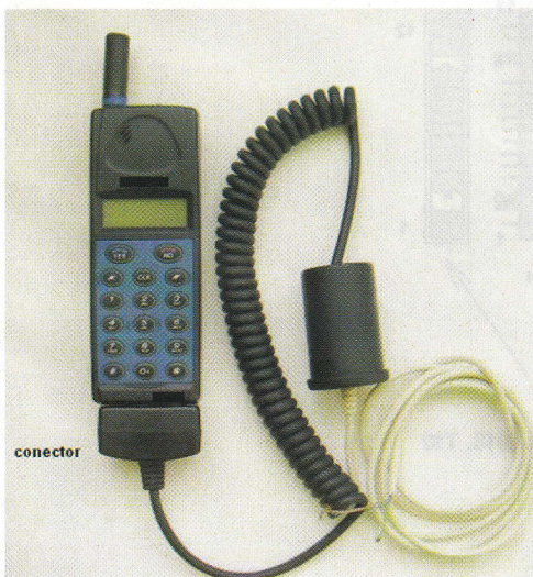
Componența experimentului - telefon, conector și interfață
