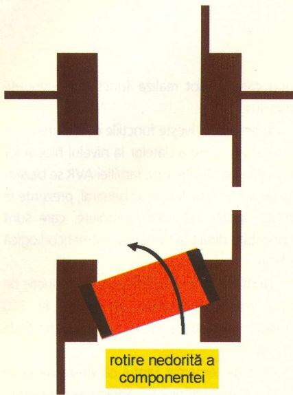
Fig. 5 Trasee multiple conectate inacceptabil la un land SMT și tendința nedorită de rotire a unui SMD
