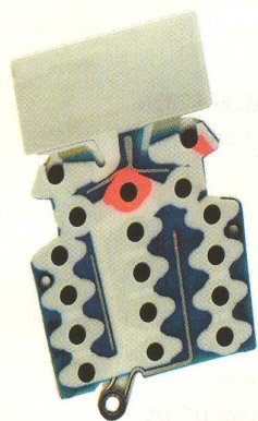
Fig. 6c PCB echipat T28, fața 2
