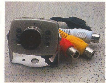
Fig. 4 Minicameră video cu captare de sunet și LED-uri IR
