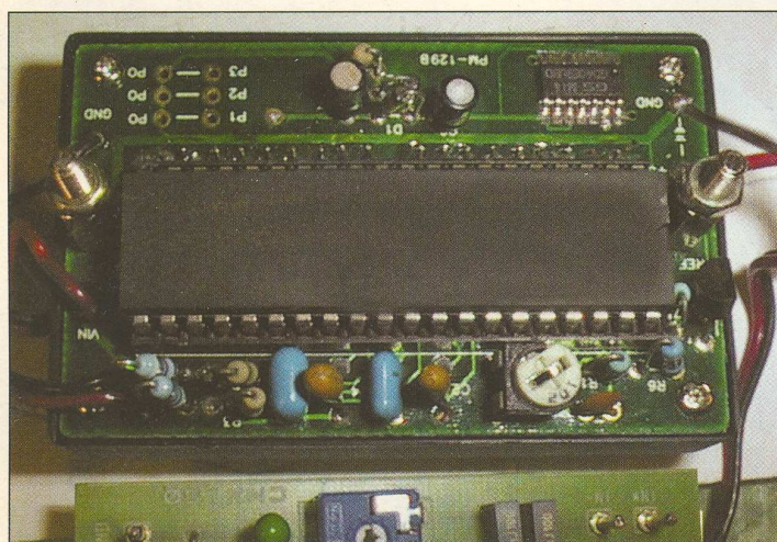
Detaliu amplasare componente panelmetru PM129-B
