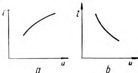
Fig. 8.6. Porțiuni din caracteristica curent-tensiune a unor elemente neliniare:
