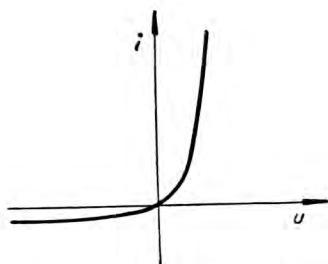
Fig. 5.9. Caracteristică curent-tensiune a unei diode semiconductoare
